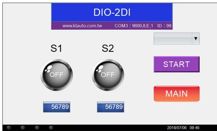
點選要測試的輸出元件，右上方下拉式選擇器，選取 DIO 元件安裝的插槽位置，按下 **START** 按鈕，按下畫面上的開關或改變滑動去上的數值，此時 IO 卡上的 LED 燈號或外接的設備會跟著變化。
