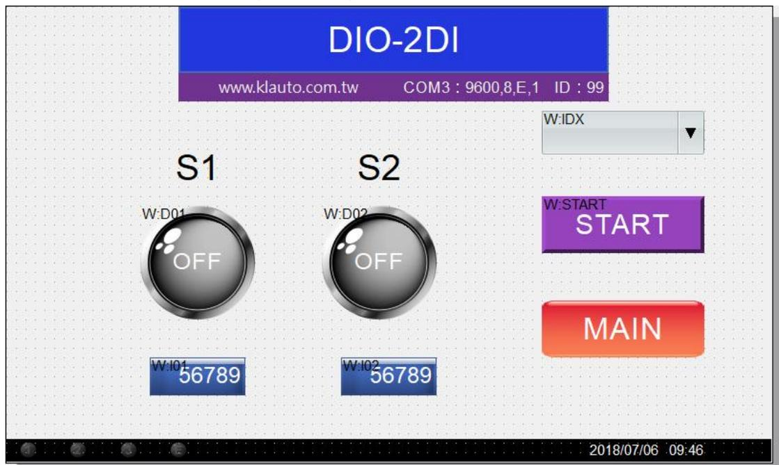
1. 輸入畫面：元件(指示燈、儀表、數值顯示)來源標籤來自 I01、I02；有些顯示需要使用經過單位轉換的標籤如 D01、D02、AI01、AI02、AV01、AV02。**必須注意！類比顯示元件的單位換算、小數點及數值範圍設定。**
